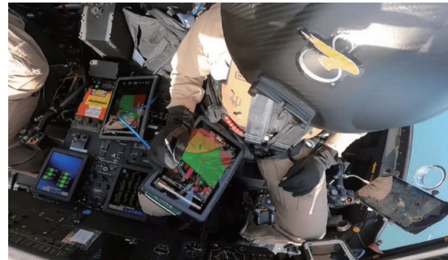
图2 在“2021项目融合”试验中,安全操控员在机上操作平板电脑控制S-70A“黑鹰”飞行。
