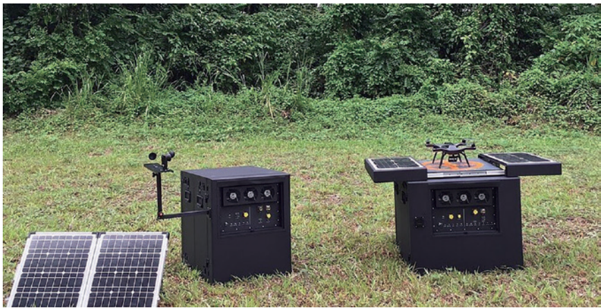
图1 “无人机亭” 无人机自动机场。
