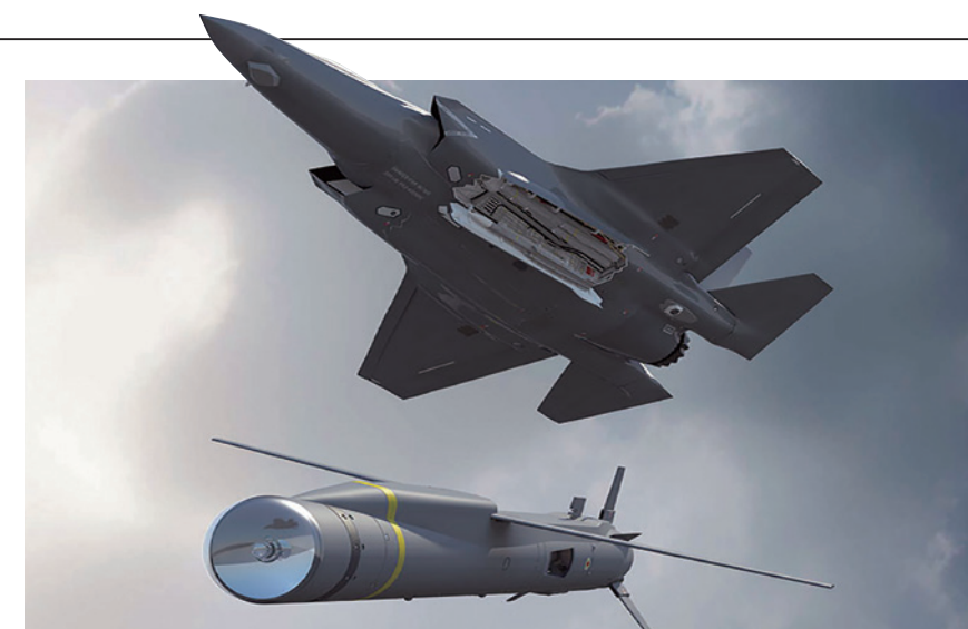
图1 美军提出新的作战概念，即F-35战斗机在空中发射无人机，形成隐身突防作战能力。
