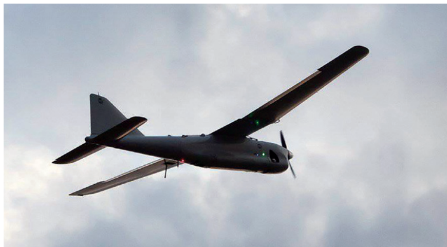
图2 “海雕”-10 无人机也可搭载干扰机执行电子战任务。
