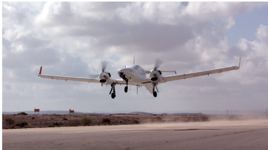
图11 “统治者”无人机由DA42“钻石”有人机改装而成。
