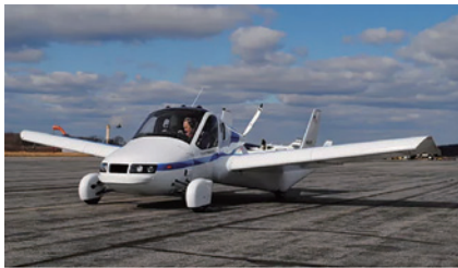
(a)TF1展开机翼变成固定翼飞机
