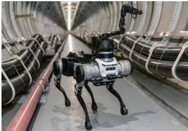
图4 四足机器人在地下空间执行侦察探测任务。
