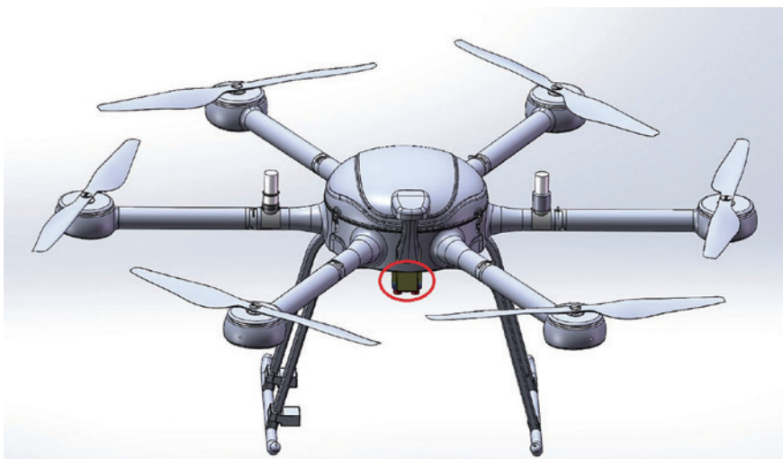
图3 断电开关的安装方式。
