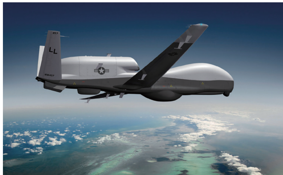
图2 诺斯罗普-格鲁门公司为美国海军研制的MQ-4C无人侦察机安装了新型“集成功能”-4传感器。
