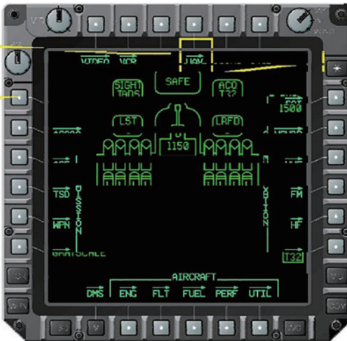
图2 作战人员助理系统显示的无人机飞行控制界面。
